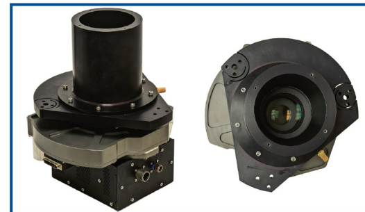
Abbildung 2.62: Der Wide Field Imager +, ebenfalls bereit für die Installation in zwei Ansichten: von der Seite (links) und von oben (rechts). Die Optik ist in dem schwarzen Zylinder untergebracht. Das graue Filterradgehäuse in der Mitte ist aus Titan gefertigt. Darunter sieht man die Kamera im schwarzen quaderförmigen Gehäuse mit den runden „Mil-Spec“-Steckern, die besonders robust und für die Anwendung im Flugzeug ausgelegt sind. Filterrad und Kamera sind bei WFI+ und FFI+ baugleich. In der Draufsicht rechts erkennt man die drei Punkte an denen der WFI+ an die SOFIA Teleskopstruktur geschraubt werden sollte (bestehend jeweils aus drei bzw. vier Bohrungen). Bei den zwei oberen Punkten erkennt man schneckenförmige Federelemente, die durch Drahtroderieren in die Aluminiumplatte geschnitten wurden. Diese dienen als Kompensationselemente, um thermische Spannungen zwischen der CFK-Sturktur des SOFIA Teleskops und der Aluminiumplatte des WFI+ zu minimieren. (Quelle: DSI)
