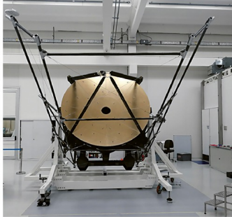
Abbildung 79: Der leichtgewichtete ASTHROS Hauptspiegel mit einem Durchmesser von 2,5 m während der Integration. Gut erkennbar sind die Einzelsegmente des Spiegels. © NASA, Media Lario
